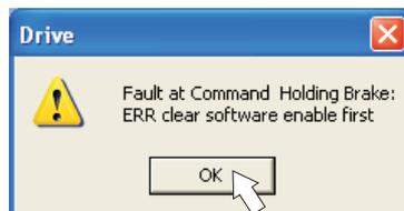
Si Software Enable está activo, aparece una advertencia. Puede continuar pero, después de reiniciar el amplificador, debe comprobar si el freno de detención está bien configurado. Haga clic en "OK".
