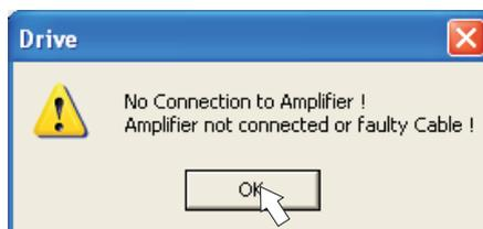
El software intentará establecer conexión con el servoamplificador. Si no se logra establecer la conexión, aparece este aviso de error.
