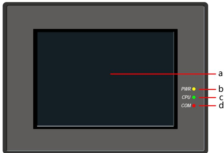
a. Screen display /Touch control area    b. PWR indicator    c. CPU indicator    d. COM indicator
