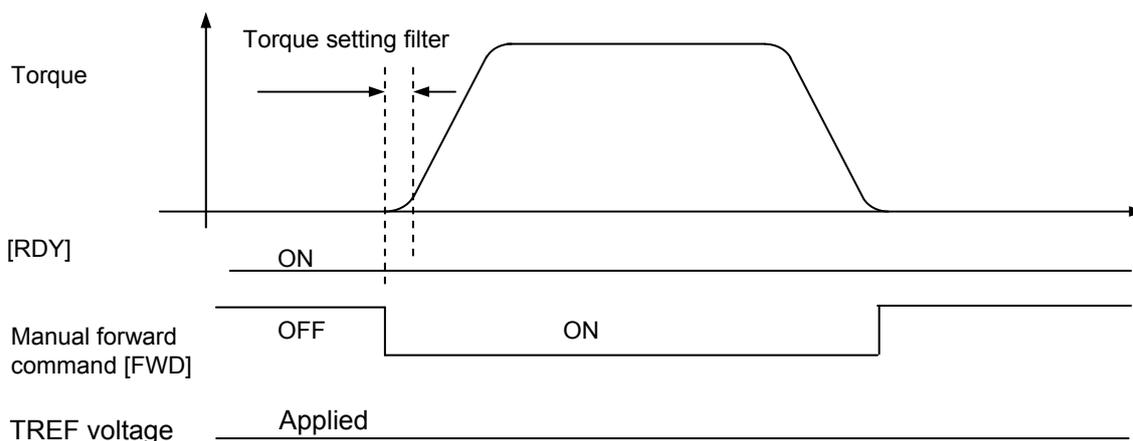
Use parameter PA1\_60 to specify the torque setting filter.
