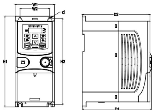
Montaje en fondo de armario de los variadores 1Ø230V/3Ø400V ≤ 2.2kW y 3Ø230V ≤ 0.75kW (mm)
