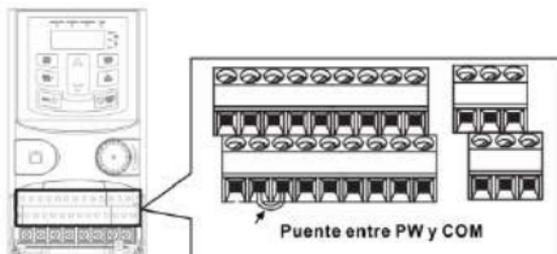
Figura 3-11 Puente entre COM y PW
