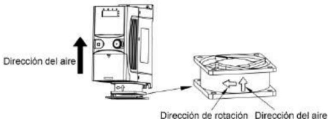
Instalación del ventilador en variadores  $1\varnothing 230V / 3\varnothing 400V \leq 2.2kW$  y  $3\varnothing 230V \leq 0.75kW$
