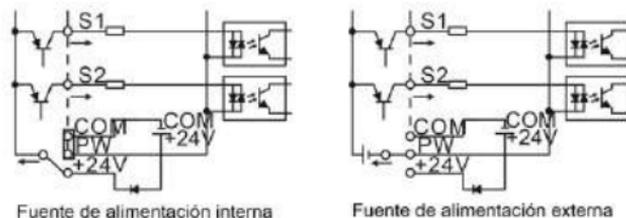
Figura 3-13 Modos de conexión PNP
