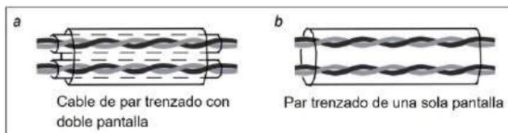
La mejor opción para las señales digitales de baja tensión es un cable de doble pantalla, pero también se puede utilizar un par trenzado con una sola pantalla o sin pantalla (Figura b). No obstante, para la señal de entrada de frecuencia, se recomienda utilizar siempre un cable apantallado.
