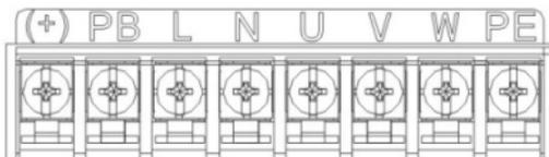
Figura 3-4 Terminales del circuito principal para variadores de entrada monofásica 230V
