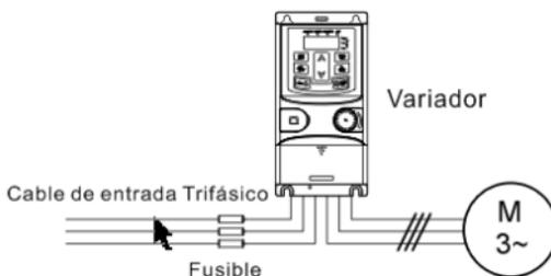
Figura 3-14 Configuración de la protección eléctrica
