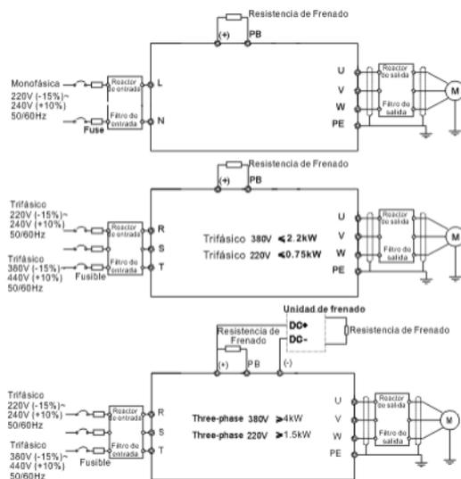
Figura 3-3 Diagrama de conexiones del circuito principal
