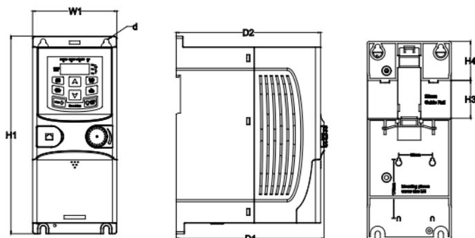
Montaje en carril DIN de los variadores 1Ø230V/3Ø400V ≤ 2.2kW y 3Ø230V ≤ 0.75kW (mm)
