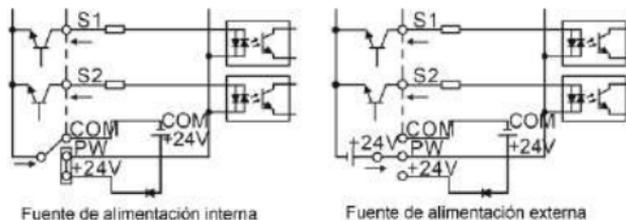
Figura 3-12 Modos de conexión NPN
