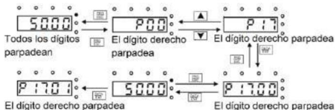
Figura 4-6 Gráfico esquemático de la inspección de estado del variador
