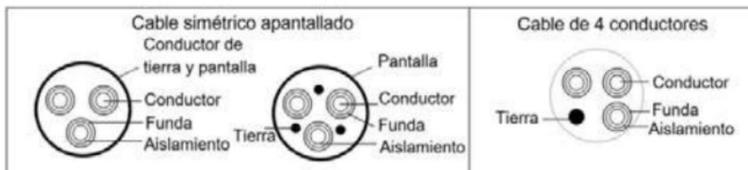
Nota: Si la conductividad de la malla del cable apantallado no es suficiente para ser utilizada como conductor de tierra, se deberá instalar un cable de tierra separado.
