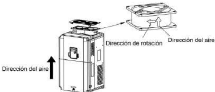
Instalación del ventilador en variadores  $3\varnothing 400V \geq 4kW$  y  $3\varnothing 230V \geq 1.5kW$
