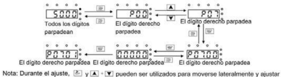
Figura 4-5 Gráfico esquemático del ajuste de la contraseña
