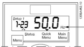
Ilustración 3.6 Indicación de la unidad del parámetro seleccionado
