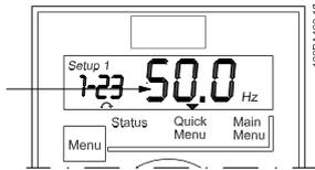
Ilustración 3.5 Indicación del valor del parámetro seleccionado
