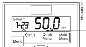
Ilustración 3.9 Indicación del modo Menú rápido
