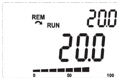
Figura 15.3: Exemplo da HMI no modo monitoração para a utilização do regulador PID
