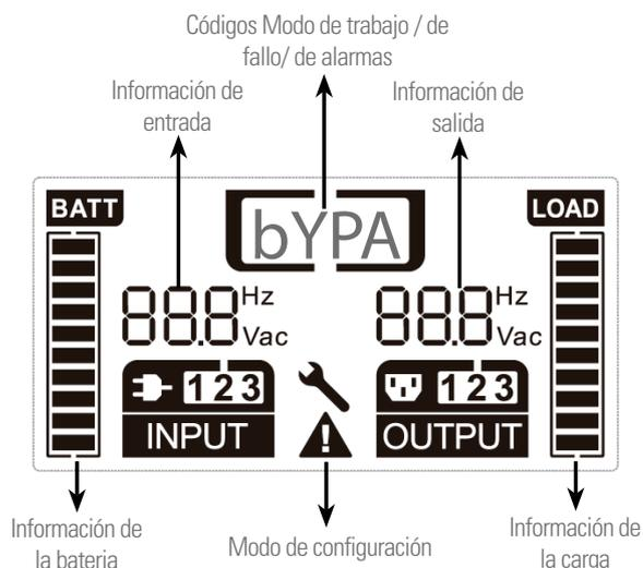
Fig. 14. Descripción display LCD panel de control.
