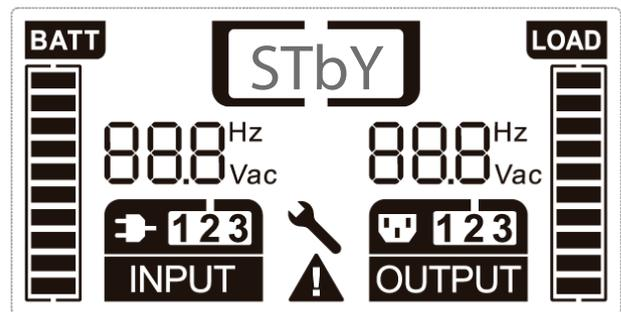
Fig. 16. Pantalla de modo de trabajo sin salida.
