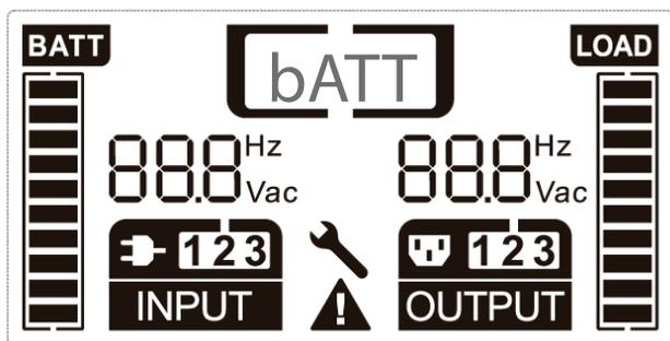
Fig. 18. Pantalla del modo de trabajo batería.
