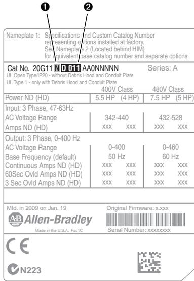
Placa del fabricante del variador 1, estructuras 1...7
